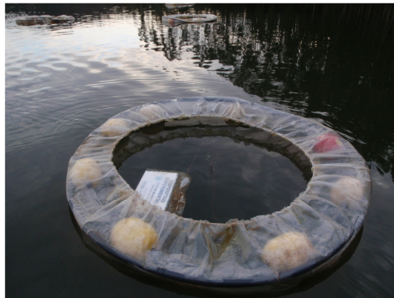
Figura S3. Limnocorrales para el estudio experimental del efecto de la fermentación anaerobia de la paja de cebada y de la viruta de eucalipto en el embalse de "As Forcadas", Valdoviño, A Coruña. Lymnocorrals to study the effect of anaerobic fermentation of barley straw and Eucalyptus shaving in the "As Forcadas" reservoir, Valdoviño, A Coruña.
