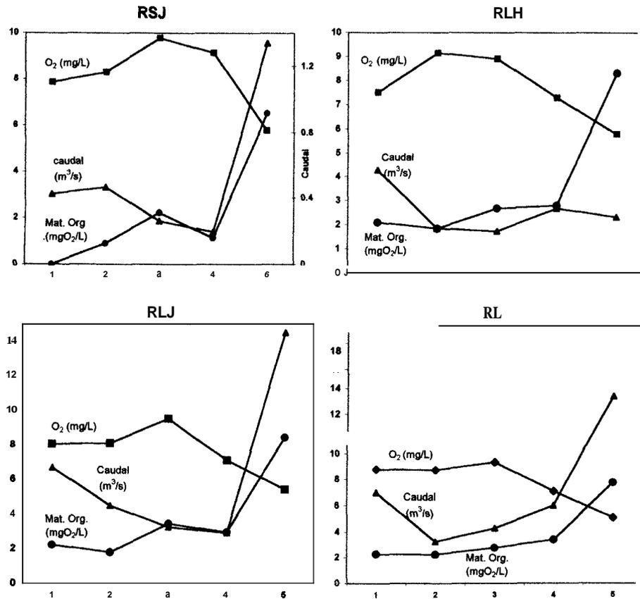
**Figura 5.** Variación del Oxígeno Disuelto, Materia Orgánica y Caudal en las estaciones de muestreo a lo largo del tiempo. ■ Oxígeno disuelto (mg/L) ●Materia orgánica (mg/L) ▲ Caudal (m<sup>3</sup>/s). *Changes in Dissolved Oxygen, Organic Matter and Flow at all sampling sites* ■ Dissolved Oxygen (mg L<sup>-1</sup>) ● Organic Matter (mg L<sup>-1</sup>) ▲ Flow (m<sup>3</sup>s<sup>-1</sup>).
