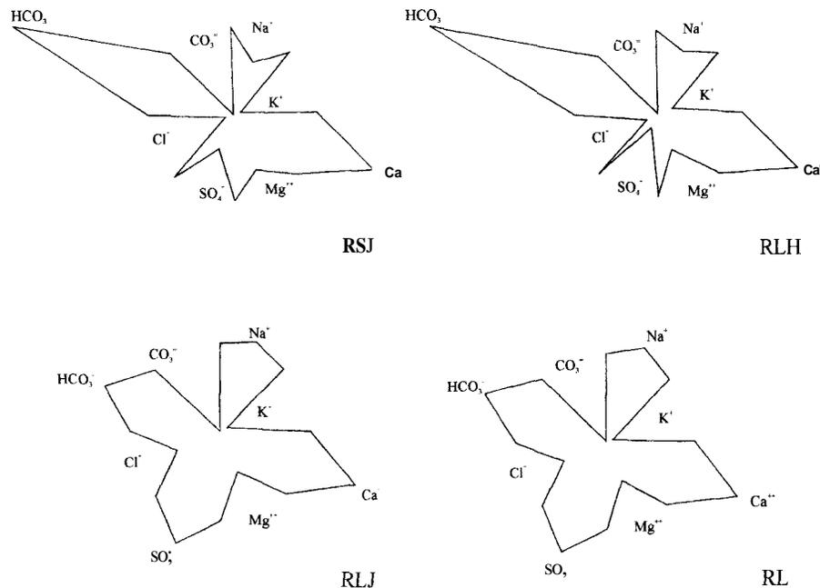
**Figura 4.** Diagramas de Maucha correspondiente a cada una de las estaciones de muestreo. . *Maucha diagrams of each sampling site.*
